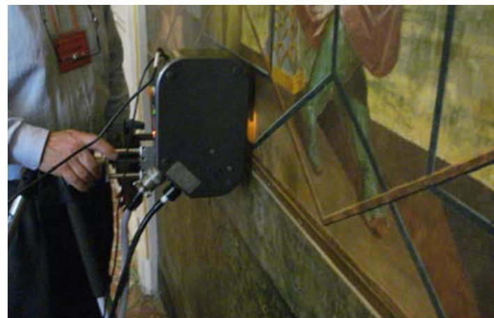
Fig. 5 - Misure in fluorescenza a raggi X
