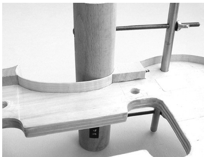
fig. 4 - Uso dei morsetti per l'incollaggio delle fasce
