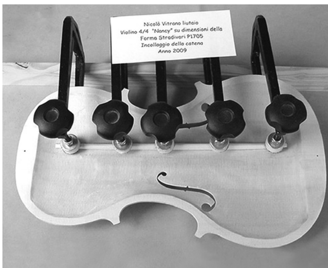
fig. 8 - Incollaggio della catena
