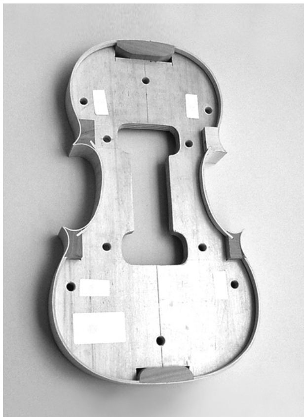
fig. 8 - Fasce sagomate e incollate
